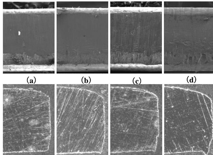
Fig. 4. Shear surface and cross section:(a)  $c/t= 3\%$ ;(b)  $c/t = 5\%$ ;(c)  $c/t= 7\%$ ;(d)  $c/t= 10\%$
