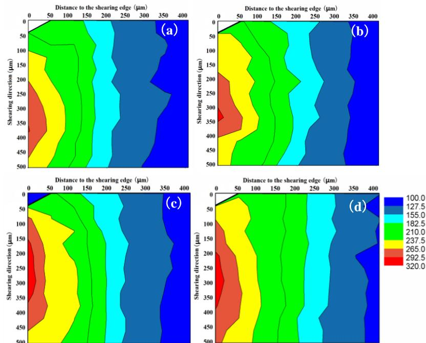
Fig. 6 Micro-hardness of different clearances:(a)  $c/t= 3\%$ ;(b)  $c/t= 5\%$ ;(c)  $c/t= 7\%$ ;(d)  $c/t= 10\%$
