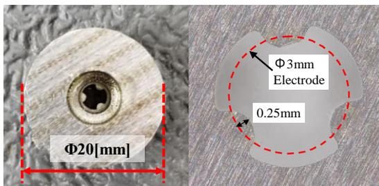
Fig. 1 Die for groove cutting
